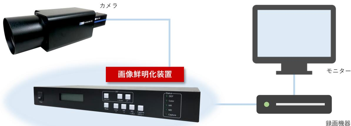
独自の画像処理技術を用いた画像鮮明化装置を組み合わせることで、霧やモヤ等で見えにくい映像も鮮明に映し出します。
